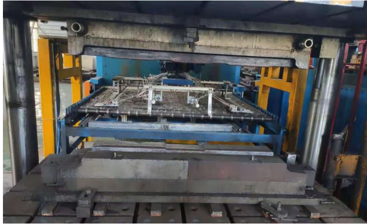
图 4 铝合金板材温热成形模具加工实物
