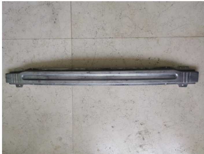
图 5 铝合金前地板座椅横梁试制零件
