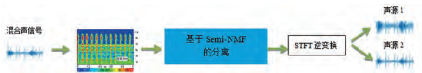
图16 基于Semi-NMF单通道声源分离技术示意图
