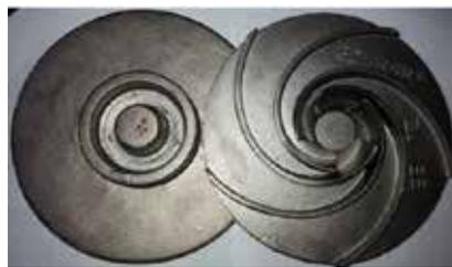
图8 离心泵叶轮金属铸件
