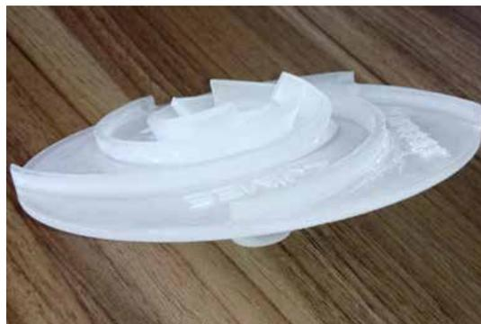
图3 后处理后的叶轮树脂原型
