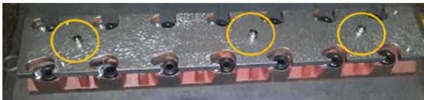
图7 装有定位销的模板
