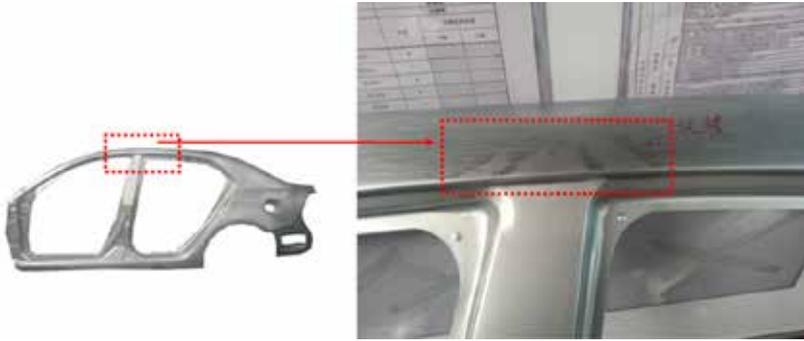
图5 B柱上部表面波浪, 凸凹不平
