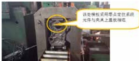
图5 采用零点定位系统的新夹具
