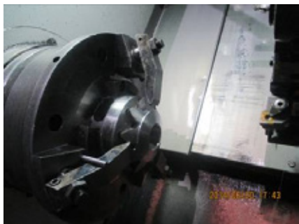
图3 在数控车床上一次装卡加工所有表面
