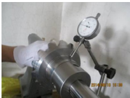
图9 在偏摆仪上检测半轴齿轮径向跳动和端面跳动误差
