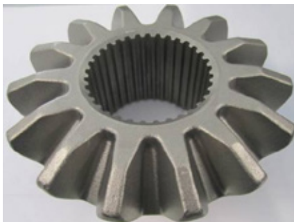
图1 行星齿轮半轴齿轮实物图
