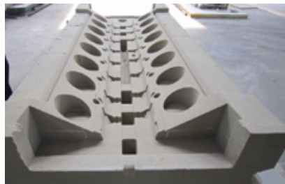
图5 铸件定位基准砂芯图
