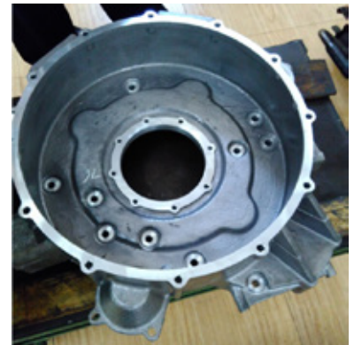
图12 某机型飞轮壳成品实物图
