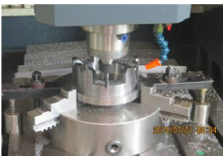
图5 在加工中心上加工定位体齿形
