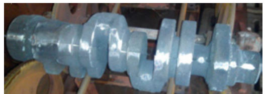
图14 某机型曲轴铸件实物图
