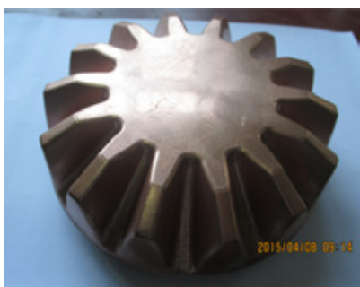
图4 改进前用作加工模具的电极
