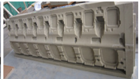
图6 铸件侧面砂芯图
