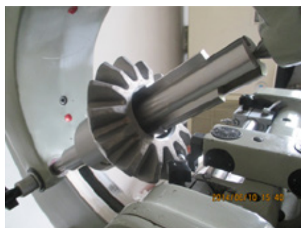
图14 在万能侧齿仪上检测齿圈径跳
