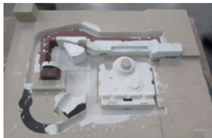
图9 某机型冷却器盖砂型
