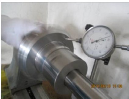
图9 在偏摆仪上检测半轴齿轮径向跳动和端面跳动误差
