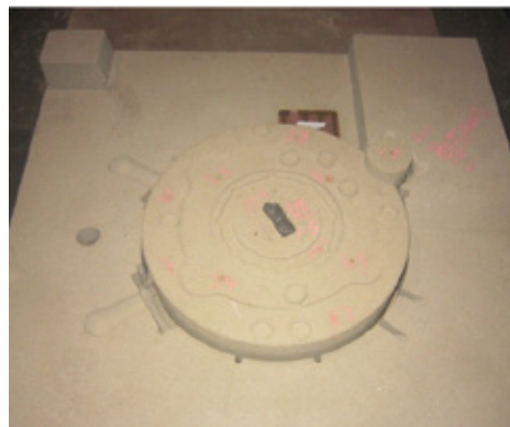
图11 某机型飞轮壳砂型图
