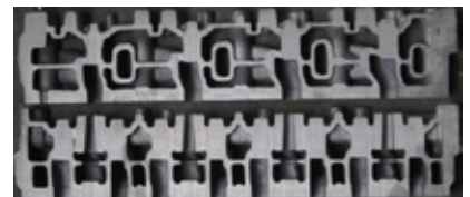
图4 缸盖铸件实物剖视图
