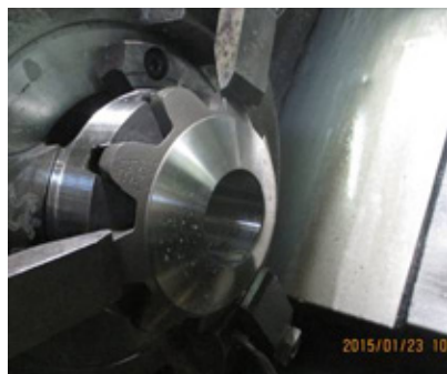
图12 行星齿轮热后车削里孔球面
