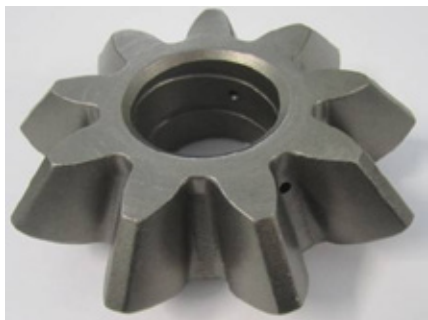
图1 行星齿轮半轴齿轮实物图
