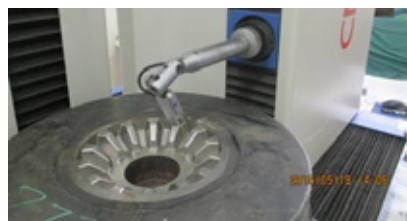
图16 在齿轮测量仪上检测模具精度
