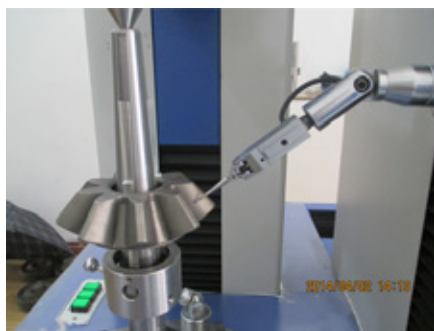
图15 在齿轮测量仪上检测齿轮精度
