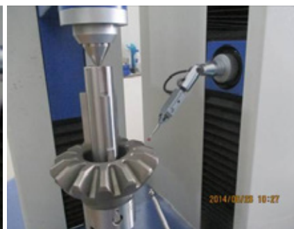
图15 在齿轮测量仪上检测齿轮精度
