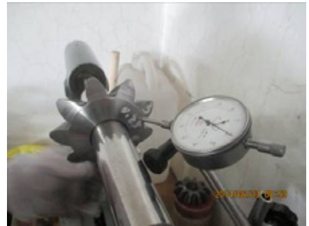
图8 在偏摆仪上检测行星齿轮球面跳动误差
