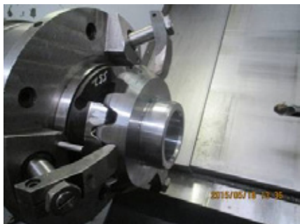
图3 在数控车床上一次装卡加工所有表面
