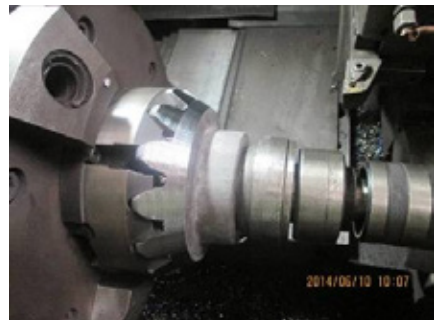
图2 半轴齿轮在数控车床上上车背锥
