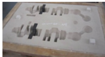
图13 某机型曲轴砂型图
