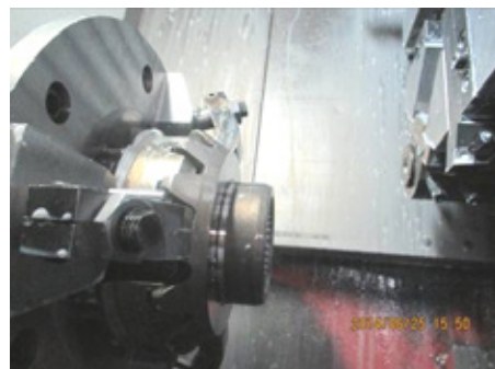
图13 半轴齿轮热后车削端面外圆
