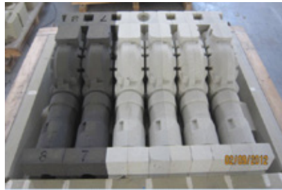
图2 机体砂模实物图
