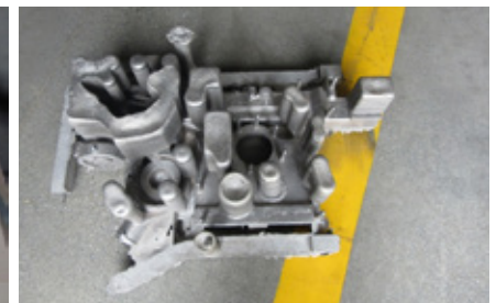
图10 某机型冷却器盖清理前铸件实物图
