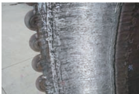
图9 气化炉内件管屏堆焊
