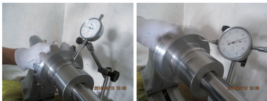
图5 在偏摆仪上检测径向跳动和端面跳动误差
