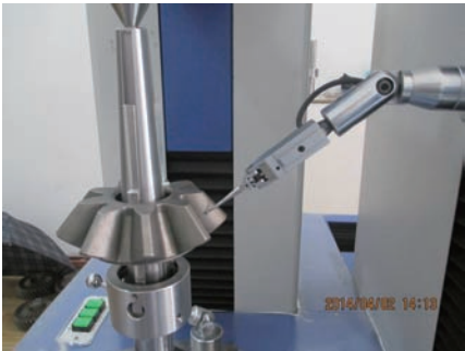
图10 在齿轮测量仪上进行单项检测
