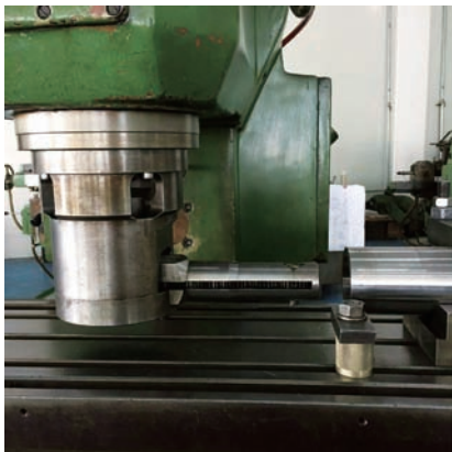
图2 Z形钻头现场加工图
