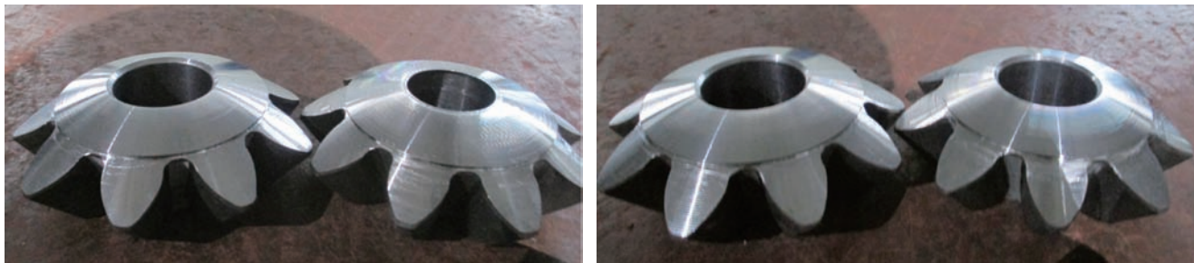
图7 倒角尺寸改进前后对比
