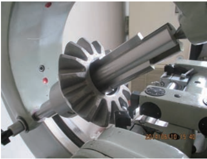
图8 在万能侧齿仪上检测齿圈径跳
