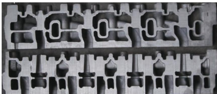
图18 缸盖铸件实物剖视图
