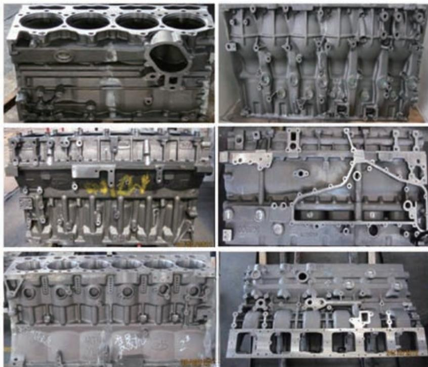
图17 先进快速制造技术制造的各种机体实物图
