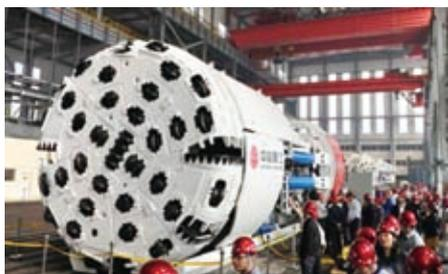
9月28日上午,中信重工与煤炭科工集团上海研究院联合研制的世界首台直径5米敞开式无轨运输硬岩掘进机成功试车。
